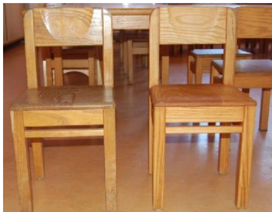
Kleuterklasstoeltjes: rechter stoeltje is geschuurd, schoongemaakt en in de Allbäck transparante lijnolie-wax gezet. Het linker stoeltje heeft nog de de versleten, vervuilde en kapotte laklaag
