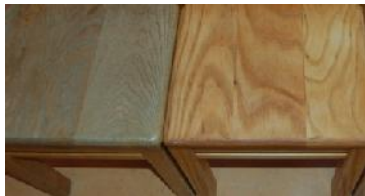
Kleuterklasstoeltjes: rechter stoeltje is geschuurd, schoongemaakt en in de Allbäck transparante lijnolie-wax gezet. Het linker stoeltje heeft nog de de versleten, vervuilde en kapotte laklaag
