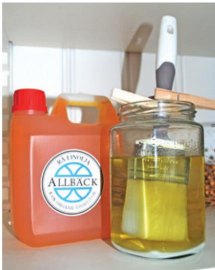
*Den Pinsel hängend in einem Gefäß mit rohem Leinöl aufbewahren. Dieses Öl kann zum Imprägnieren verwendet werden.*
