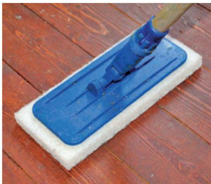
*Leinölwachs lässt sich am leichtesten mit einem rauen Scheuerschwamm (z.B. Scotch Brite) auftragen*
