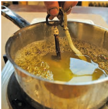
Rengör beslag från färg och rost med kokning i linsåpa.
