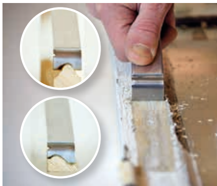
Lillskrapan är enkel att slipa och forma till profiler.
